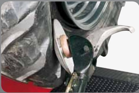
Détalonnage du pneumatique Fase de destalonadura neumático Fase de descolagem do pneu
